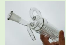
既製品にはない性能を追求した 化学実験用高効率冷却管
