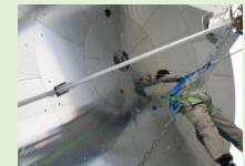
電波望遠鏡（NANTEN2）での サブミリ波用セグメント鏡形状測定作業
