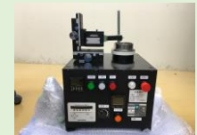
新たに設計・開発された 汎用型摩擦試験機
