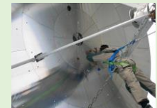
電波望遠鏡（NANTEN2）での サブミリ波用セグメント鏡形状測定作業
