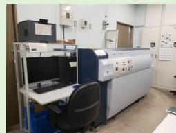
飛行時間型質量分析計 (MALDI-TOF-MS)
