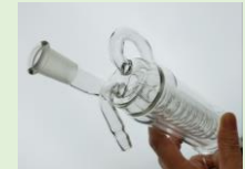
既製品にはない性能を追求した 化学実験用高効率冷却管
