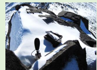
山岳地帯等の過酷な環境での 遠隔通年地震観測システム構築
