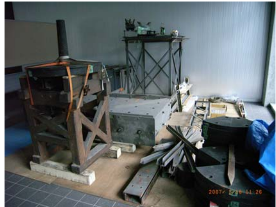
図1 分解して運ばれた地震計
