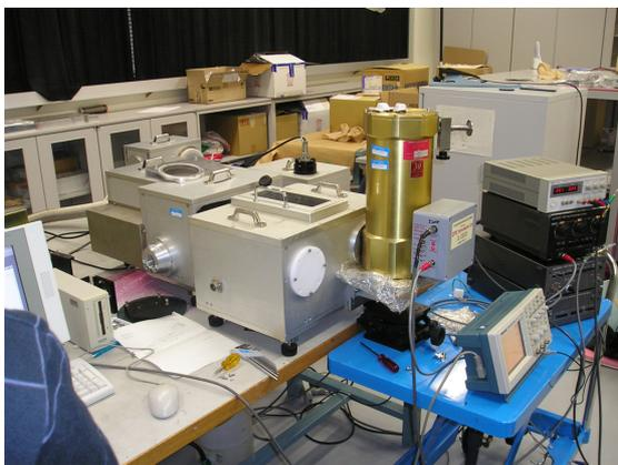
写真5 フーリエ分光光度計による測定
