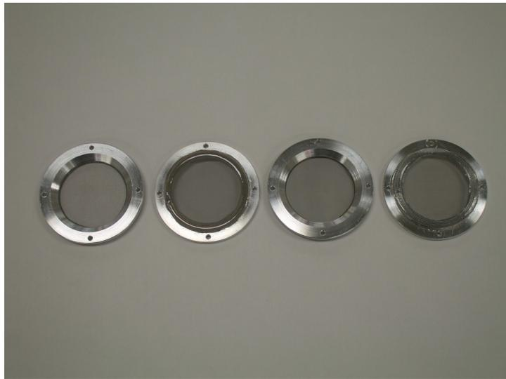
有効直径 40 mm ワイヤー直径20  $\mu$  m ピッチ 60  $\mu$  m
