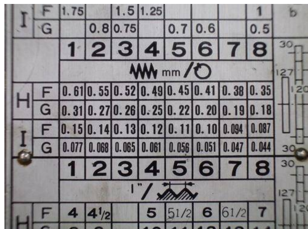
写真5, 自動送りのピッチ表: 60 μmはない
