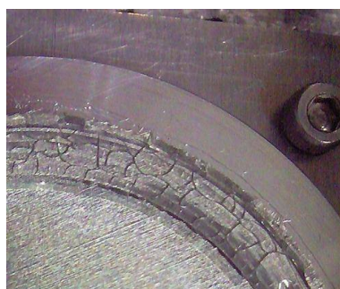
写真 2，冷却後の接着面
