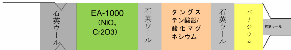
図6. 燃焼管の試薬充填構造
