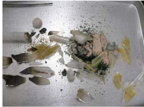
図 3. 燃焼管破損下部
