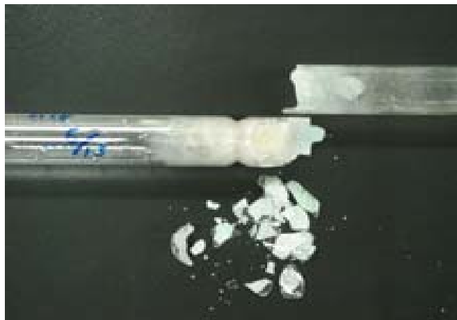
図5. 燃焼管破損部分の拡大図
