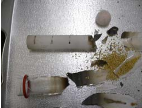
図 2. 燃焼管破損上部
