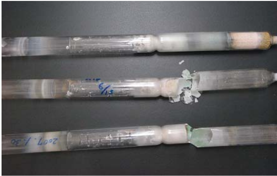
図4. 上段：破損していない燃焼 中段：2006.6.13 破損 下段：2007.1.30 破損
