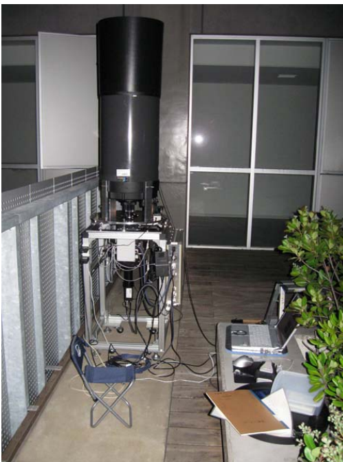
図5 京都大学生存圏研究所でのテスト観測の風景。バルコニーに受信機を設置して観測を行った。レーザー光源は、建物の中にあり望遠鏡とは約13m離れている。
