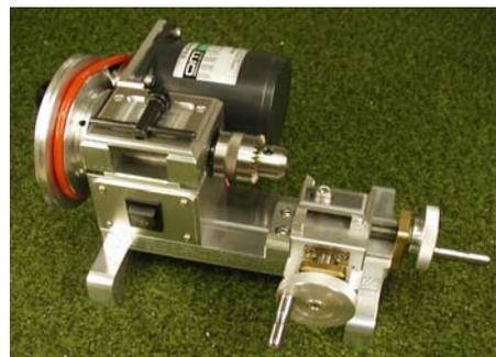
図1. 学生が製作した汎用旋盤
