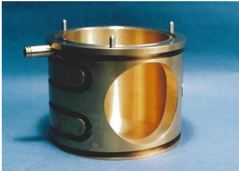
写真 2. CNC 旋盤による M 軸複合加工
