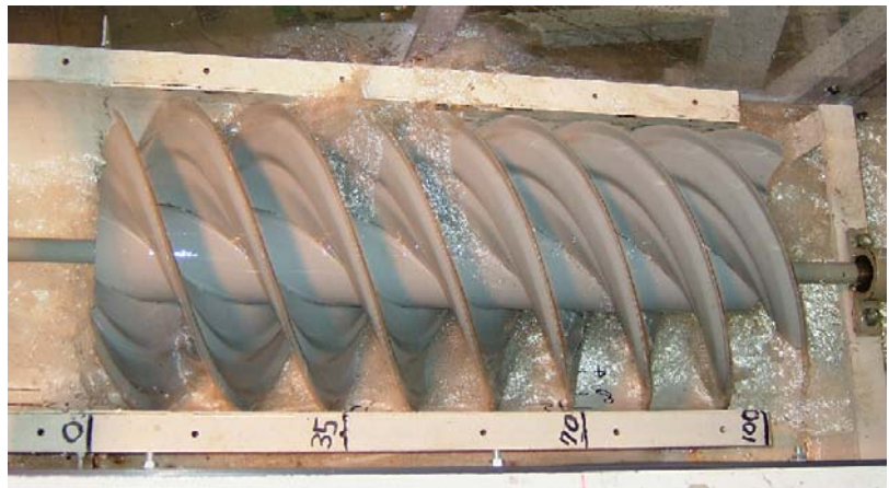
写真 1 富山県立大にある実験用らせん水車 (当時の 1/2 サイズのモデルで直径 450mm、全長 1m、 水は左側から右側に流れ水車が回転する)
