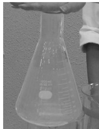
図. 減圧を利用してフラスコを持ち上げたところ
