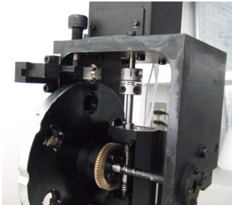
図 10. 反射防止の黒色処理をした装置
