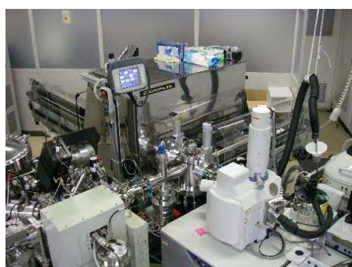
図 6. 冷却搬送システム 左から全体外観・液体窒素タンクとポンプ (中間チャンバーへ輸送)
