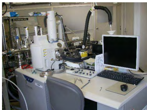
図 7. 走査電子顕微鏡 左から全体外観・赤外線カメラシステム (試料ホルダー移動中)
