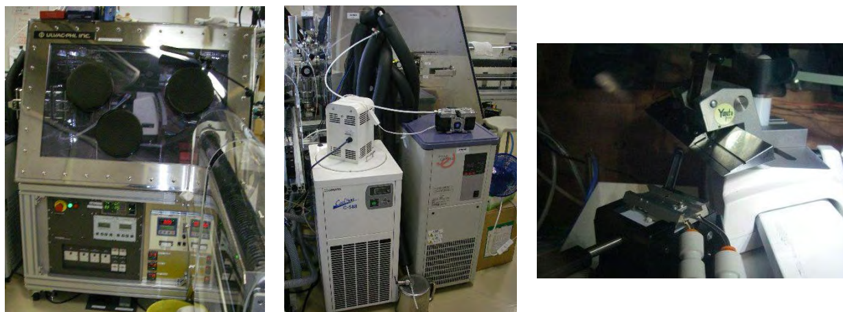
図 5. グローブボックス 左から前処理室・チラー2台とドライポンプ・リトラトーム
