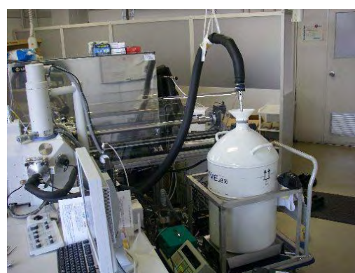
図 6. 冷却搬送システム 左から全体外観・液体窒素タンクとポンプ (中間チャンバーへ輸送)
