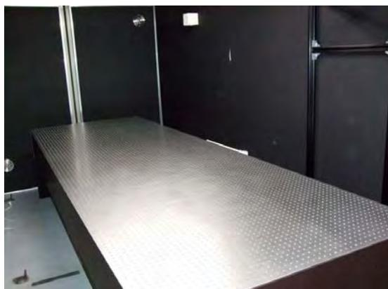
図 8 送信コンテナに納められた光学定盤
