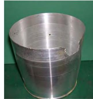
写真 1 ワックス固定の一部が剥がれ、ミラー偏心による加工例
