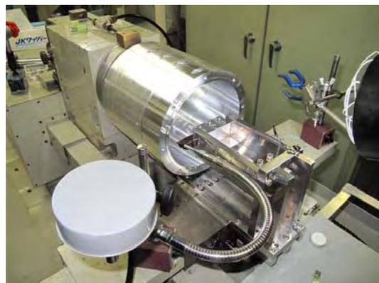
写真 3 超精密旋盤 (UPL-1 : 理研製鋼社製) によるミラー内周加工
