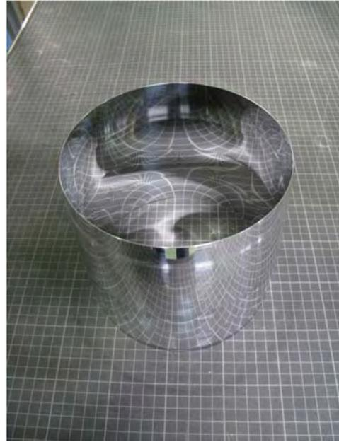
写真5 分割外側治具加工法で試作したミラー
