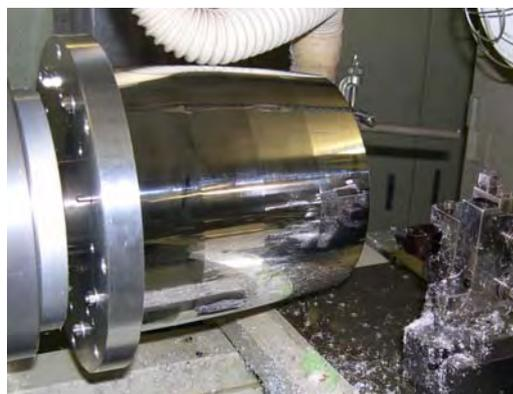
写真 2 超精密旋盤 (UPL-1 : 理研製鋼社製) によるミラー外周加工
