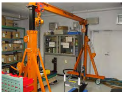
写真 8. 組立用の移動式クレーン (1t)
