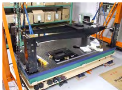
写真 11. 大型対物レンズの架台組立
