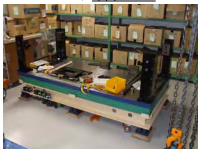
写真 9. Z 軸の支柱を立てる
