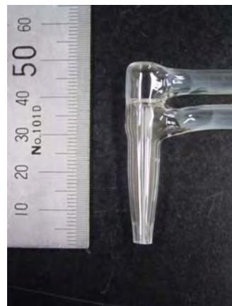
図 5. バーナー先端部拡大写真
