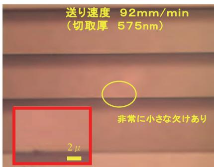
図18 角溝列顕微鏡写真
