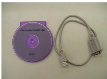
写真4 USB-シリアル変換ケーブルと
