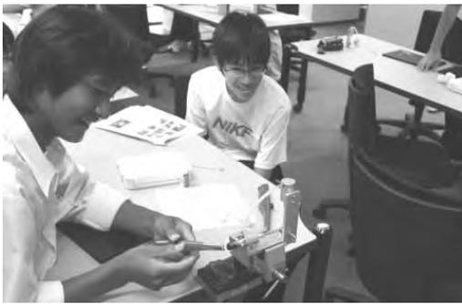
図2 エンジン性能試験のようす
