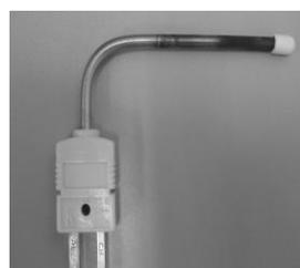
図. 交換後の温度センサー
