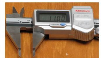
図4. 新しく入手したノギスによる標点距離の測定
