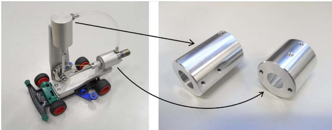
図7 加熱・冷却ヘッド
