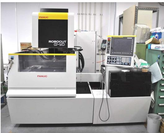
図 1. ワイヤ放電加工機
