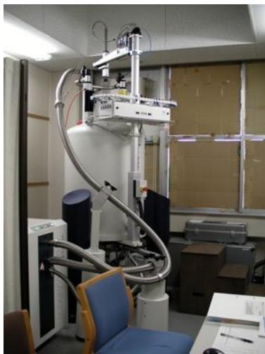
図 4. 核磁気共鳴分析計「AVANCE-III 400MHz Nanoboy」
