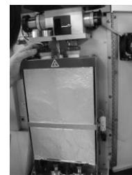
図7. CHNS 燃焼カラムを装置に装着
