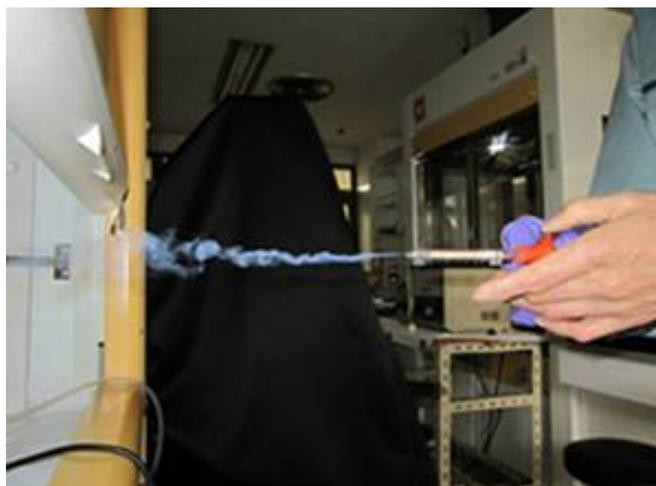
図.4 気流検知器（AS-1型）
