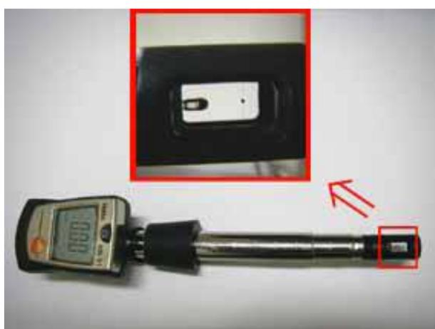
図.1 熱線式風速計
