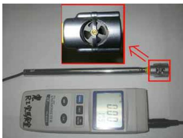
図.2 ベーン式風速計
