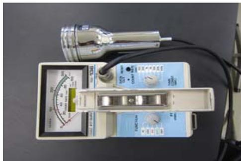
図.13 GM管式サーベイメーター
