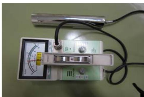
図.14 NaIシンチレーション式サーベイメーター
