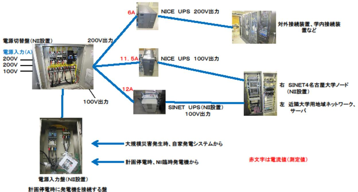
図 4. 送電図 (導入後)
