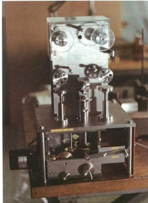
図1 無歪型結晶切断器
