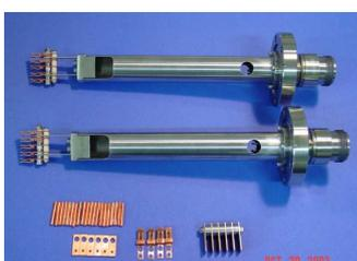
図8 電子衝撃型加熱装置
