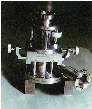
図3 超高真空用試料台
