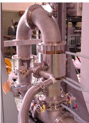
図7 大型熱音響冷凍機
