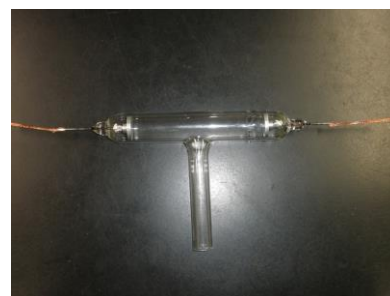
図 3. 製作したガイスラー管
