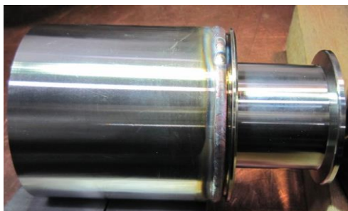
図 4. 溶接中の真空容器
