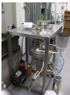
図7. オーバーホール後の真空排気装置
