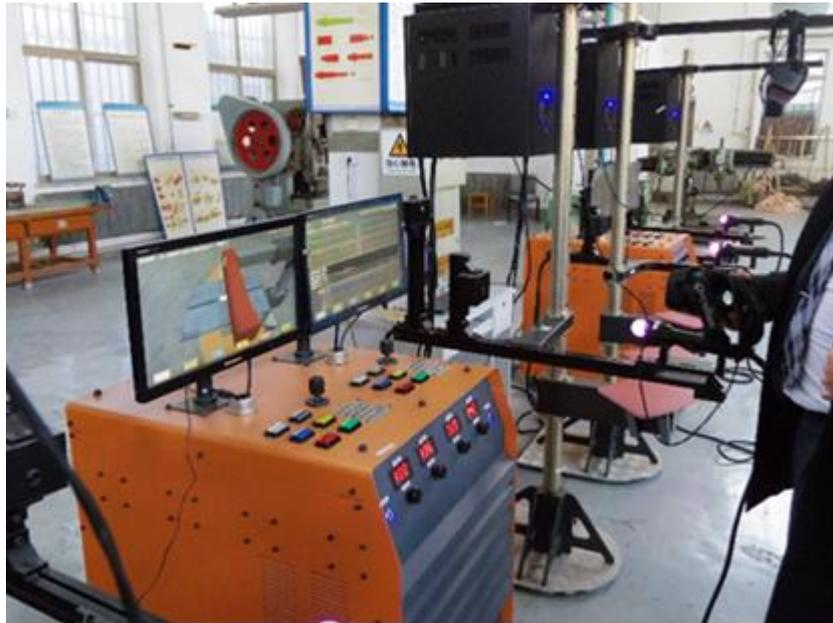
図 2. VR による溶接手技の教育訓練装置
