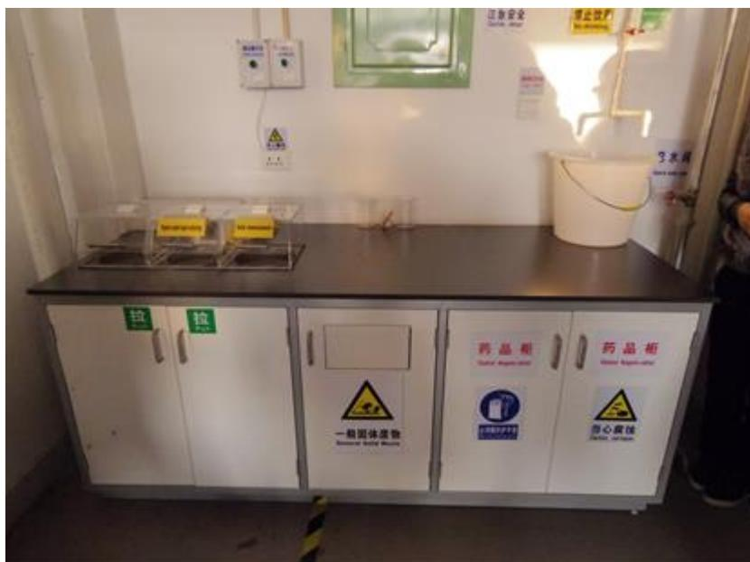
図7. 部屋の隅に設置された実験廃棄物回収場所
