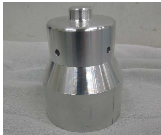
図 6. 複合加工機で加工したサンプル
