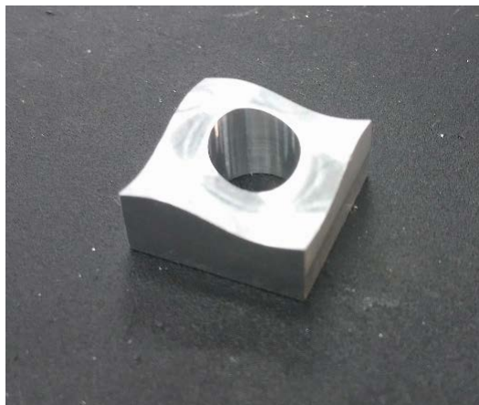
図 2. 3 軸加工機で加工したサンプル
