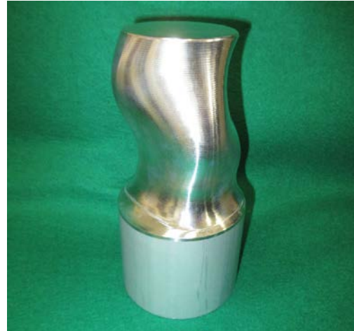
図 4. 5軸加工機で加工したサンプル
