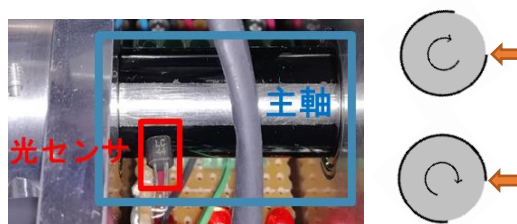
図 4. 主軸と光センサーとその読み取り
