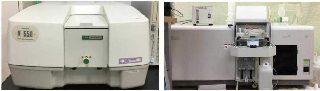
図 1. 紫外可視分光光度計（左）と原子吸光光度計（右）
