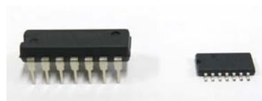
図4. DIP（左）と表面実装型SOP（右）パッケージ
