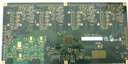
図 7. SciCRT バックエンドボード
