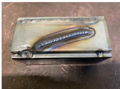
図 1. SUS 溶接 (ビードオンプレート)
