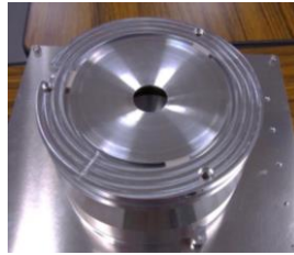
(5) コリメータ内リングを取り付けたコリメータ外リングを、スペーサーを介して外殻に固定する。
