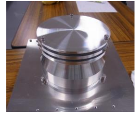
(6) コリメータ上板を、スペーサーを介して取り付ける。
