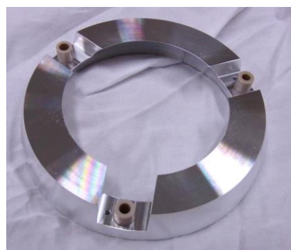
図 2. スペーサーを挿入した中殻の下側
