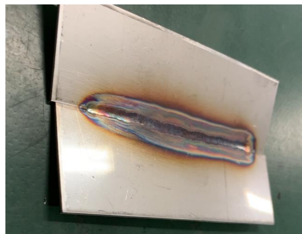
図 2. 突き合わせ溶接した試験片
