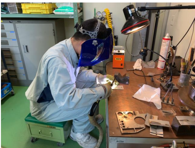
図 1. 共付け溶接の様子
