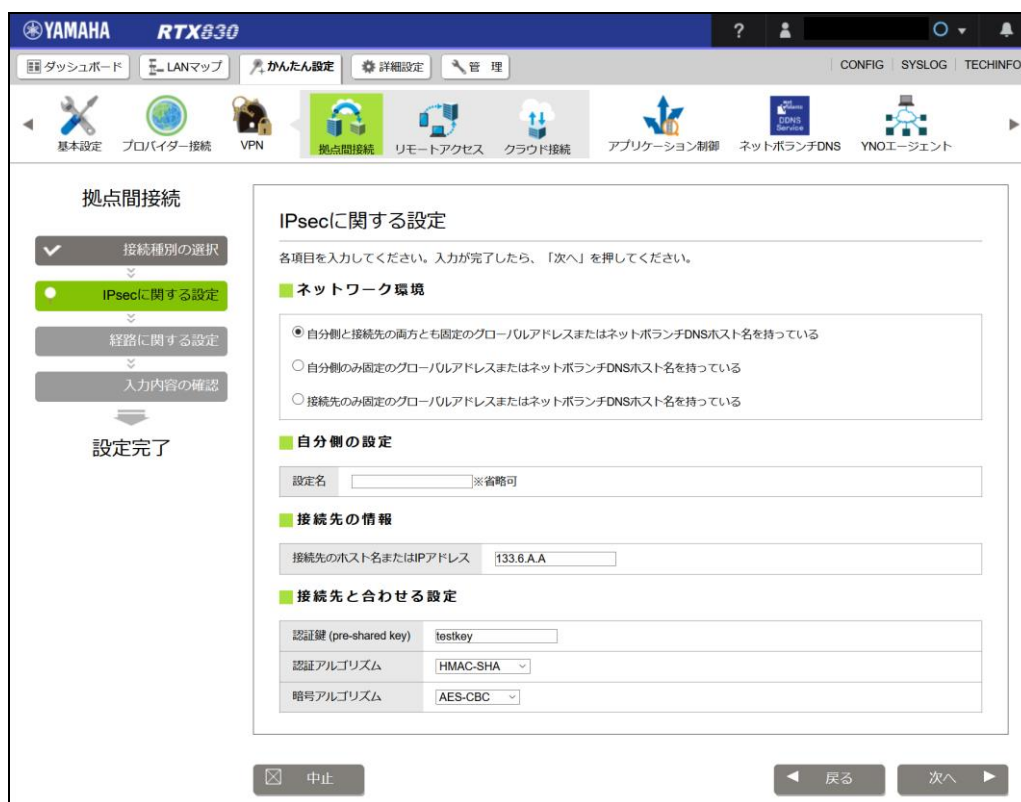
図 2. RTX830 の拠点間接続の設定画面
