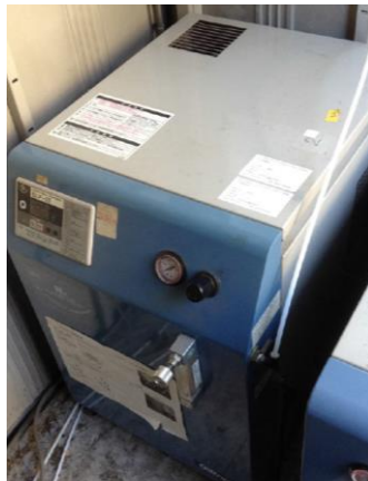
ESI-イオントラップ型質量分析計(NUESSD17)の付帯設備、望遠ガス発生器 パネルを取り外すことが困難なため、望遠ガス発生器の全体像
